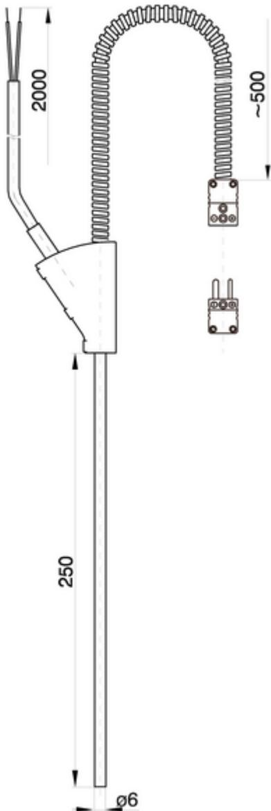
Für alle Thermoelementprüfungen mit erhöhten Genauigkeitsanforderungen besonders in Kalibrierlaboren.
