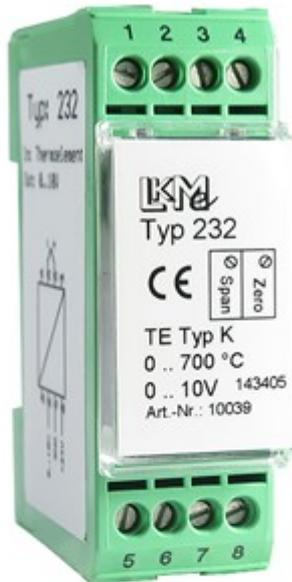
Galvanisch getrennter analoger Messumformer für Thermolemente zur Montage auf 35mm Tragschiene mit 0..10V-Ausgangssignal
