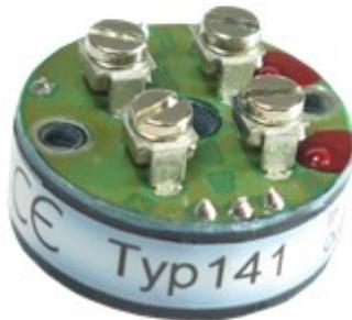
Analoger Messumformer für Thermoelemente im F-Kopf mit 4...20mA Ausgangssignal
