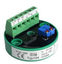
Analoger Messumformer für PT100/PT1000 zur Montage im B-Kopf mit 0..10V-Ausgangssignal und 24V Versorgungsspannung
