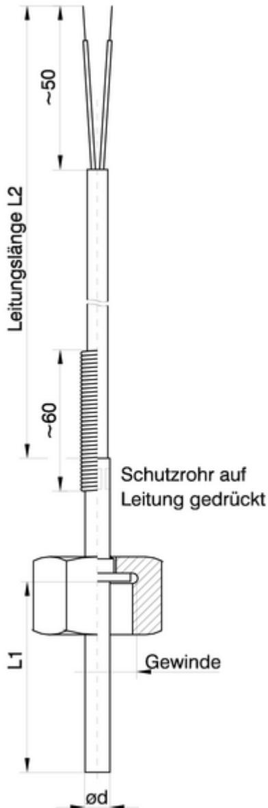
Thermoelement-Kabelfühler mit Überwurfmutter
