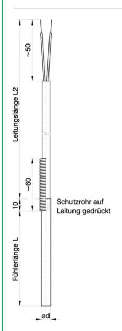
Thermoelement-Kabelfühler zum Einstecken
