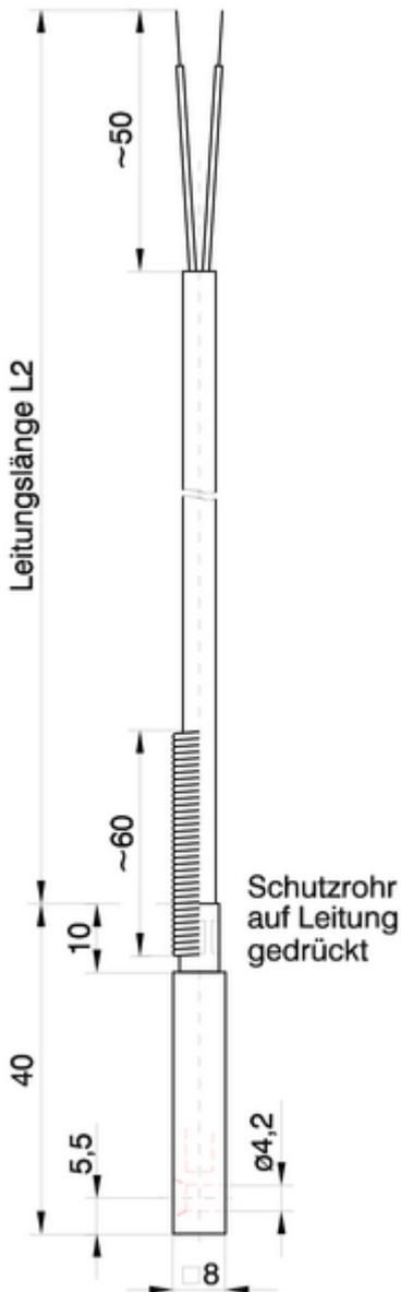
Thermoelement-Kabelfühler zur Oberflächenmessung
