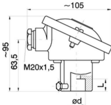
Anschlusskopf für Widerstandsthermometer und
