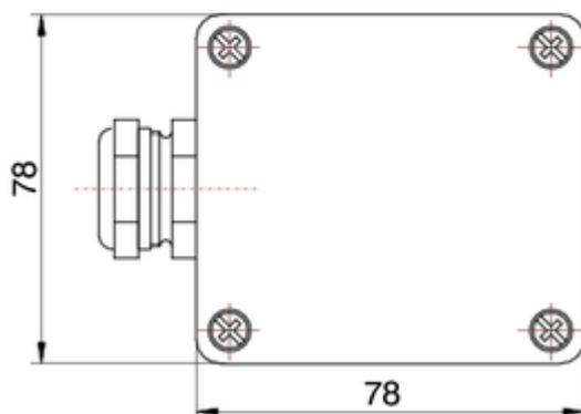
Widerstandsthermometer im Alu-Gehäuse zur Oberflächenmessung mit Magnet; Ausführung auch mit eingebautem Messumformer möglich (Ausgang 4...20mA oder 0...10V)
