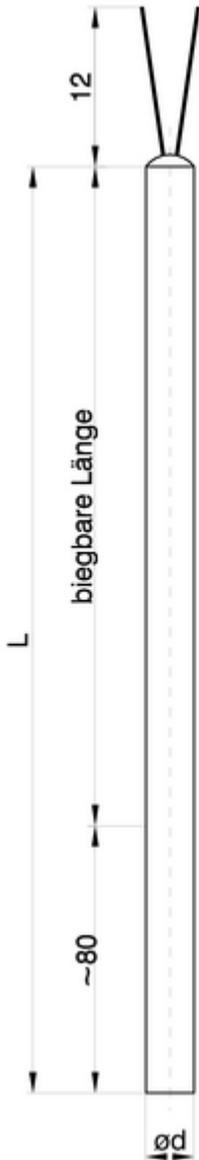
Mantelwiderstandsthermometer mit freien Enden
