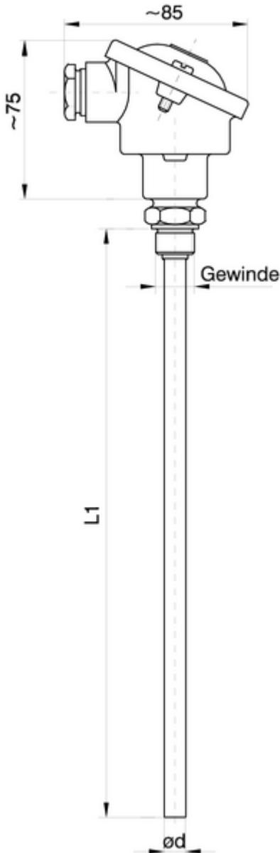
Widerstandsthermometer zum Einschrauben mit auswechselbarem Messeinsatz
