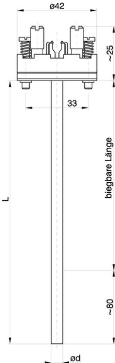
Messeinsatz aus Mantelleitung zum Einbau in Schutzarmaturen (biegbar,  $r > 5 \times \text{Drahtdurchmesser}$ )
