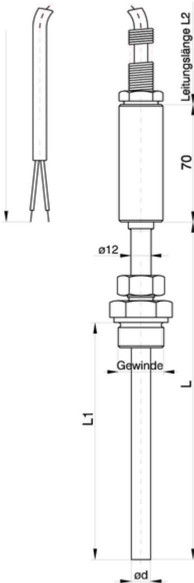
Widerstandsthermometer mit Anschlussleitung
