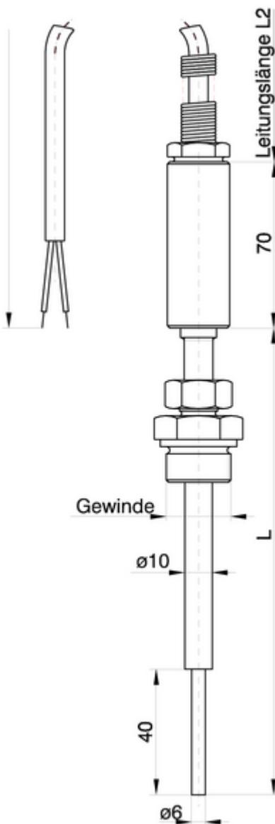
Mantelthermoelement mit verstellbarer
