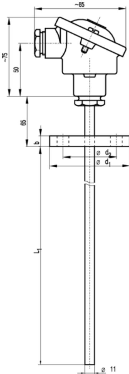
Thermoelement mit Flansch und auswechselbarem Messeinsatz
