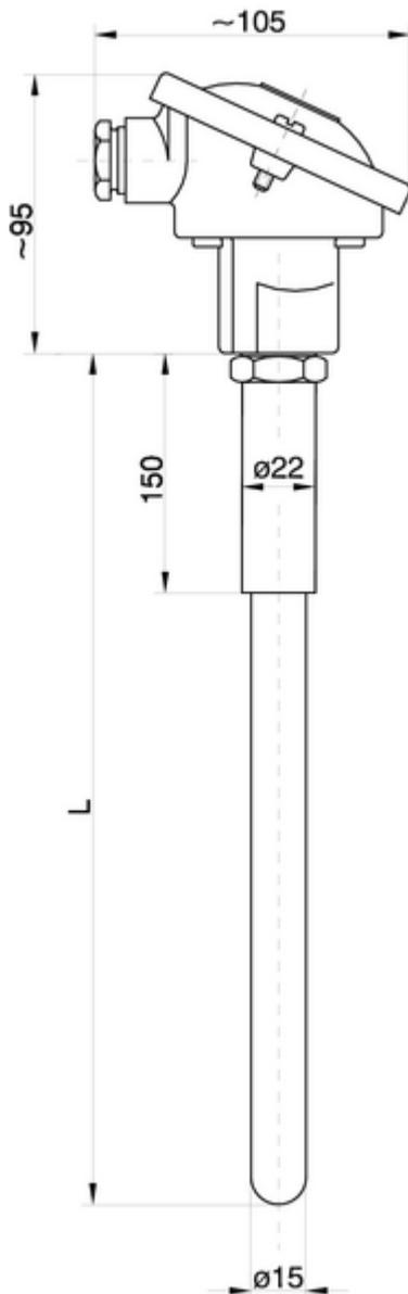
Thermoelement mit keramischem Schutzrohr und Halterohr aus Edelstahl,
