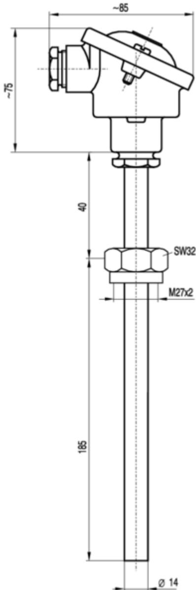
Thermoelement mit auswechselbarem Messeinsatz
